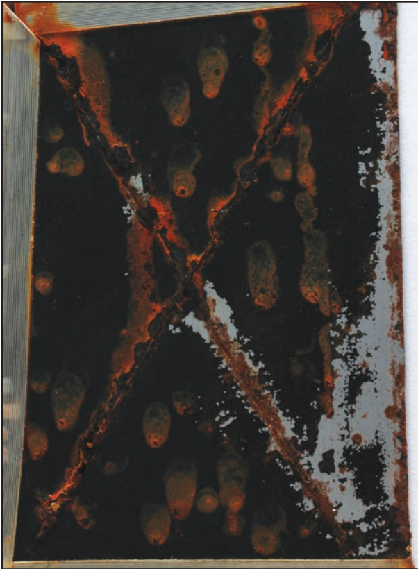
Konventionelle Beschichtung mit TFS von 6-8 µm nach 350 Std. heißem Salzsprühtest (ASTM B117). Starke Migration sichtbar. Gravierende Korrosion. Standard-Klebeband löst Beschichtung.
