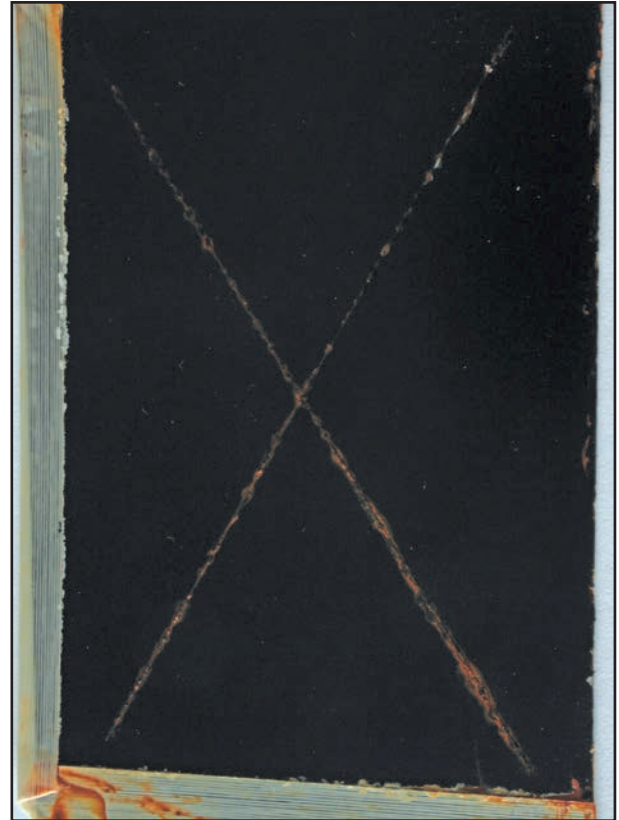
Skandia Xtreme Plus mit TFS von 7-9 µm nach gleichem Test. Keine evidente Migration. Korrosion nur wo Prüfplatte angeritzt wurde. Auch nach 5x Abziehen mit Klebeband hält Beschichtung.
